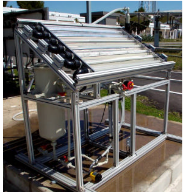
Dispositivo experimental autónomo para desinfección solar de agua en entornos rurales aislados de países en vías de desarrollo
